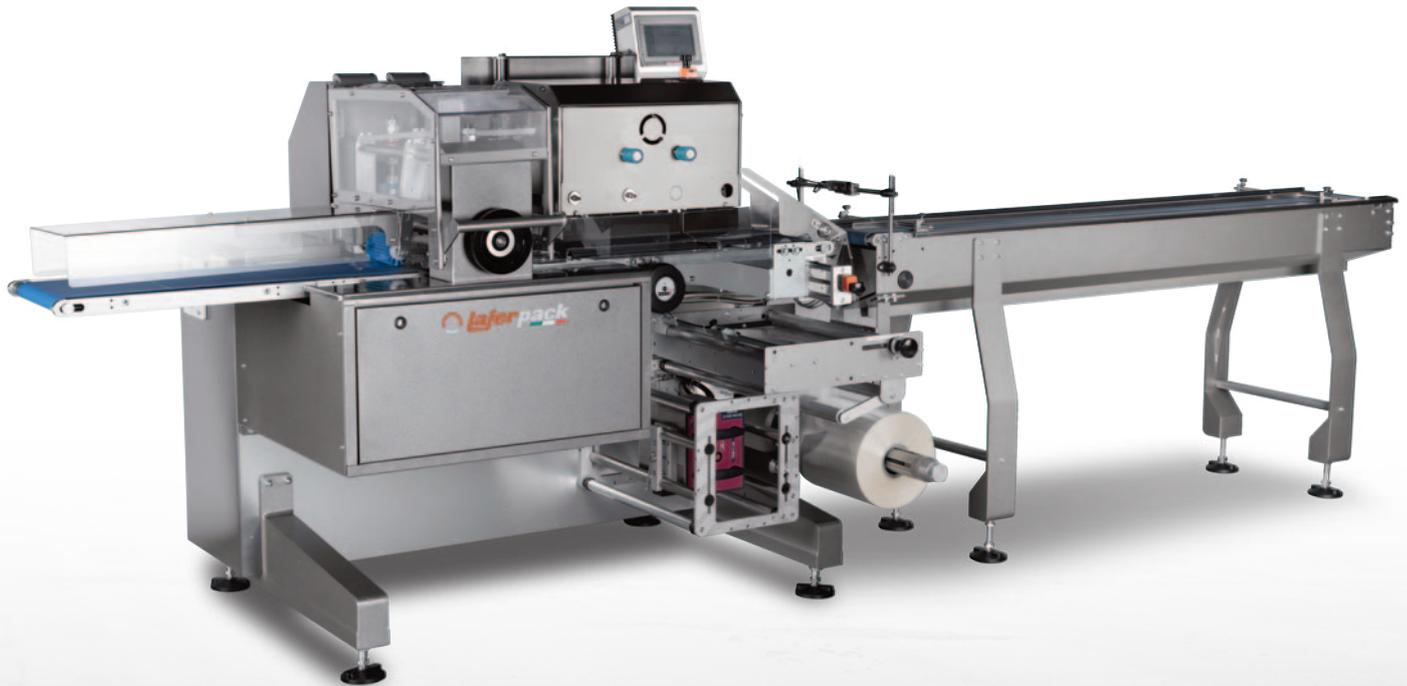
Confezionatrice orizzontale a tre assi elettrici brushless con bobina dal basso studiata appositamente per applicazioni con caricamento manuale dei prodotti, con gli stessi punti di forza delle macchine Laferpack di alta gamma: esecuzione a sbalzo; touch screen a colori da 7 pollici con interfaccia intuitiva; completo accesso all'area operativa della macchina.
